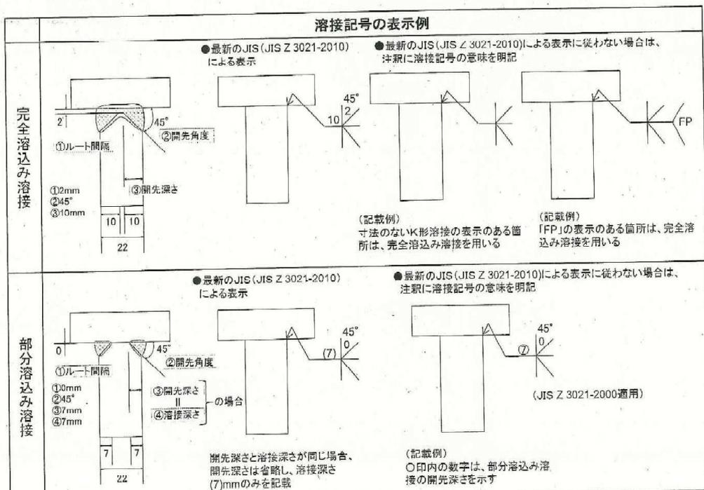
※図中の形状寸法は、溶接記号を説明するためのイメージとして記載したものであり、実際の形状寸法は設計に従うものとする
